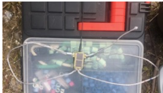
Links: VHF-zender en rechts PTT-satellietzender met harnas
